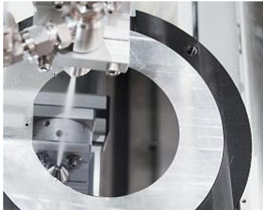
Mit der trockenen quattroClean-Schneestrahlschnittechnologie lässt sich eine partiikuläre Sauberkeit entsprechend ORK 1 reproduzierbar erreichen. Bei filmischen Rückständen entsprechen die Reinigungsergebnisse denen, die mit anderen Feinstreinigungsverfahren erzielt werden.
