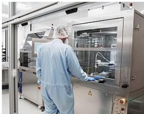
Die Prozessauslegung und Definition der optimalen Prozessparameter erfolgen im eigenen Reinraum-Technikum. Die Aufbereitung der Prozessmedien Kohlendioxid und Druckluft stellt dabei eine Luftqualität sicher, wie sie beispielsweise in der Halbleiter-Produktion gefordert wird.
