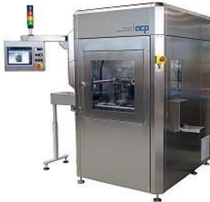
Die kompakte, aus Edelstahl gefertigte Reinigungszelle JetCell mit Rotationsdüsen wurde für die automatisierte Reinigung entwickelt und ermöglicht eine hohe Flächenleistung in kurzer Zeit. Sie kann einfach in verkettete Fertigungsumgebungen eingebunden oder als Standalone-Lösung betrieben werden.
